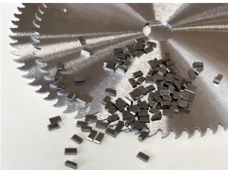
モンド工具は、耐久性が約30倍～50倍の耐久性があり、使用して頂いているお客様には喜ばれる切削工具であり、またPCDを刃先にロウ付けし刃先に加工をします。ダイヤの加工はダイヤモンド砥石での加工、EDM放電加工の作業を行い、刃先精度0・03ミリ以内の精度で刃物を仕上げます。刃物は、鋸、カッター、ルーターの種類があり、様々な測定器で検査を行い、ユーザー様に自信を持った製品提供しています。
