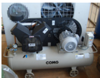
エアコンプレッサー
