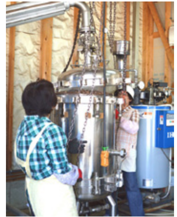
試行錯誤して開発した蒸留抽出装置
