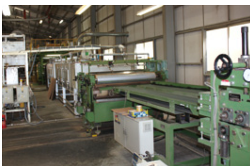
全長30メートルのラインを持つ機械 ラミネーター
