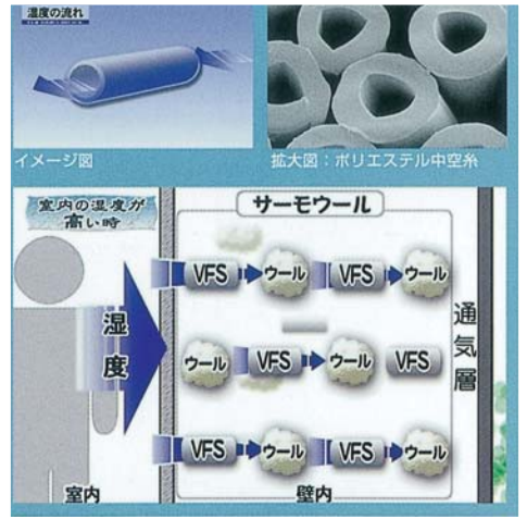
水蒸気を湿度の高い方から低い方に移動させ、羊毛の調湿効果を最大限に発揮する。
